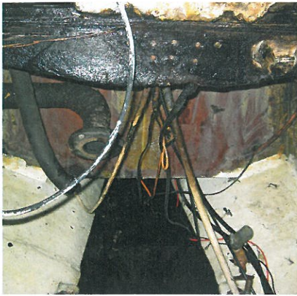
Träregeln under durken i motorrummet fick bytas ut och själva durken fick plastas om.
